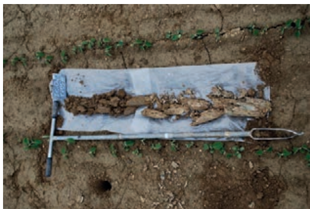
Fig. 2.5: Esempio di ricostruzione del profilo di suolo estratto con trivellata a mano.
